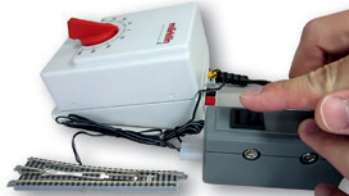
Weichenanschluss an Trafos anderer Hersteller (hier: Märklin®)
