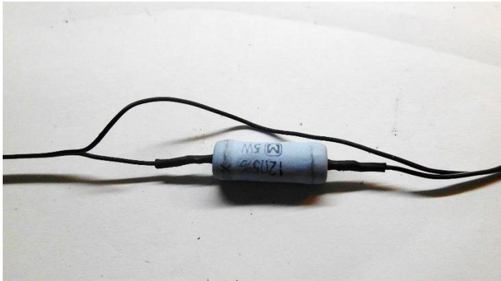
4. Im Anschluss wird er Schrumpfschlauch über die verlöteten Kabelenden gezogen und mit dem LötKolben vorsichtig geschrumpft.
