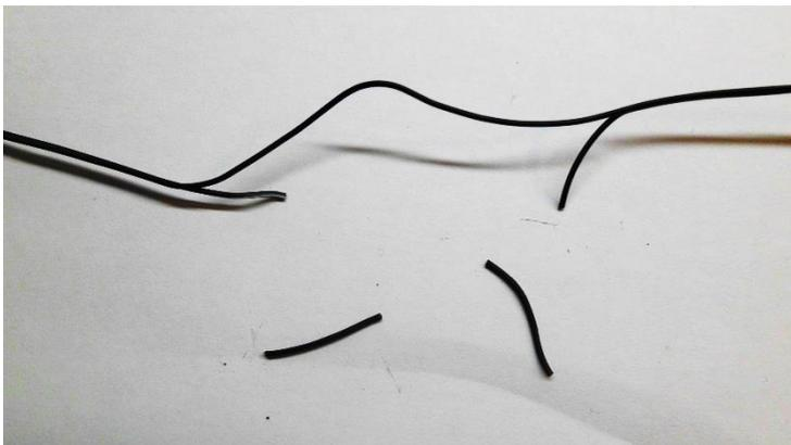
1. Das Anschlusskabel (Art.-Nr. 7297408) ist gemäß Abbildung links mittig um ca. 50 mm aufzutrennen und die offenen Enden um 20 mm zu kürzen. Im Anschluss sind die offenen Enden um 3 mm abzuisolieren.
