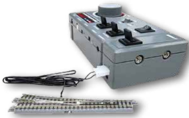
Weichenanschluss an Weichenschalter mit Fahrregler „RC03“
