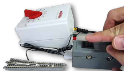
Weichenanschluss an Trafos anderer Hersteller (hier: Märklin®)
